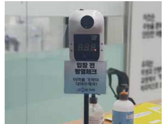
비접촉식 간편 체온 측정기 설치
